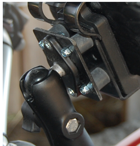
Montage an Zwischenplatte zur Verbindung mit anderen Aufnahmesystemen bei abweichenden Lochabständen
