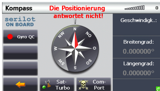
Bild 6: ComPort falsch konfiguriert
