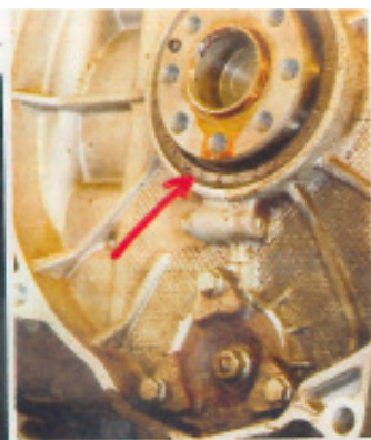
Wie beim Boxster: Der Kurbelwellendichtring (Pfeil) hielt nicht mehr dicht
